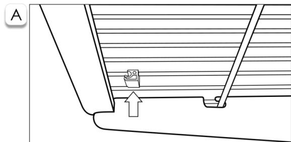
Верхняя часть клипсы имеет канавку под поперечную проволоку. Приложите клипсу к проволке снизу полки (рис. А) и задвинте клипсу в планку до фиксации (рис. В).
