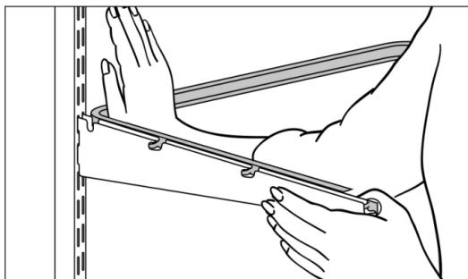
U - образная рамка имеет три металлических язычка и выступ с каждой стороны (расположены в верхней части рамки) для жесткой фиксации рамки в кронштейнах.
