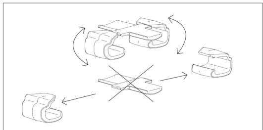
Поместите корзину в выдвинутую рамку и зафиксируйте пластиковыми клипсами, как показано на рисунке с обеих сторон. Клипсы поставляются в комплекте с деревянной рамкой.
