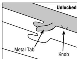
Удерживая переднюю часть кронштейна с рамкой, надавите на закругленную часть от себя до защелкивания выступа.
